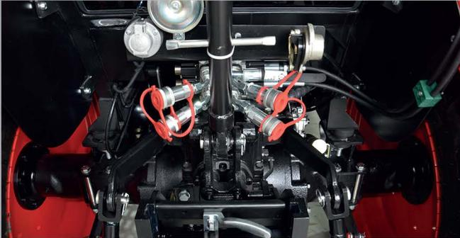
Гидравлическая система трактора проста в обслуживании. Оснащена гидравлическим шестерённым насосом, обеспечивающим подачу рабочей жидкости до 40 л/мин. Гидравлический распределитель двухзолотниковый, с открытым центром; золотники имеют «плавающее» положение и тросовое дистанционное управление. Рабочее давление в гидравлической системе 180 бар. Две пары свободных гидравлических выводов расположены в задней части трактора.
