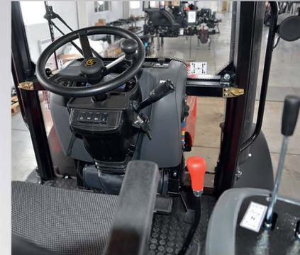
Трактор оборудован каркасной кабиной с большой площадью остекления. Кабина оснащена регулируемой по углу наклона и вылету рулевой колонкой, подрессоренным сиденьем, электронной комбинацией приборов, системами отопления, вентиляции и кондиционирования. Поступающий в кабину воздух очищается встроенными фильтрами. Передний и задний стеклоочистители оснащены омывателями. Заднее стекло также может быть оборудовано электрическим подогревом.
